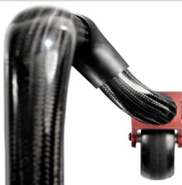
KRF010301 Ángulo standard del tubo de la horquilla, más abierto, y posición de la rueda adelantada
